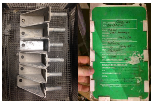
Bildet til venstre viser stillasesko som er blitt kappet.
