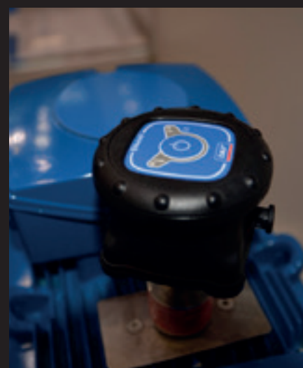
SKF har utviklet dette verktøyet for å måle vibrasjoner i bl.a. motoren. Resultatet kan leses av på en dataskjerm.
