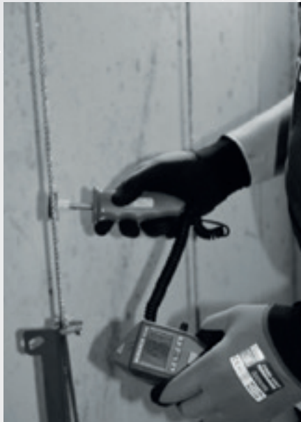
Utløserhastighet måles med ett tachometer
