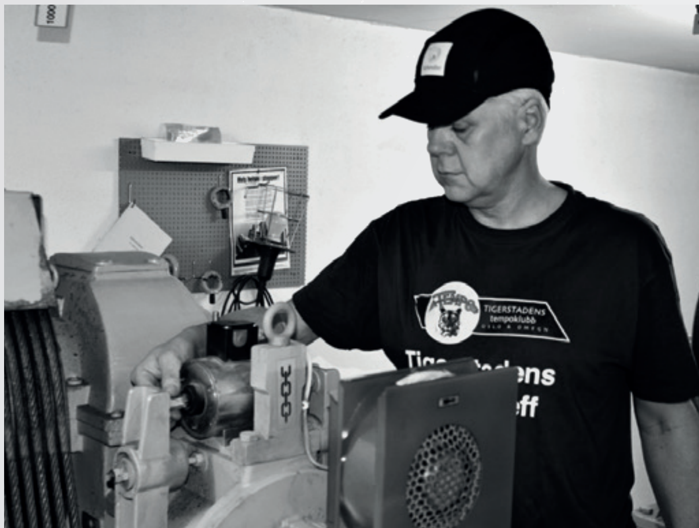
Kontroll av brems
