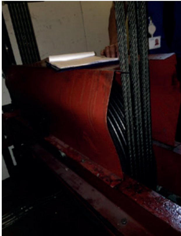
Deformert skivedeksel på stoltak etter sammenstøtet
