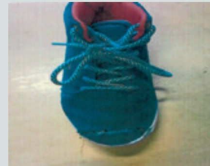
Sko ble fastklemt mellom to rulle-trapptrinn og fulgte med inn i kamplate ved avstigning. Ingen personskade.
