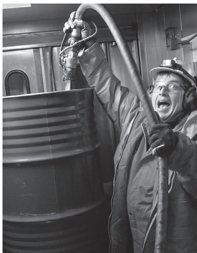
Her fylles oljefat for å få vekt i stolen ved utføring av fangtest under årskontroll på Oseberg Sør
