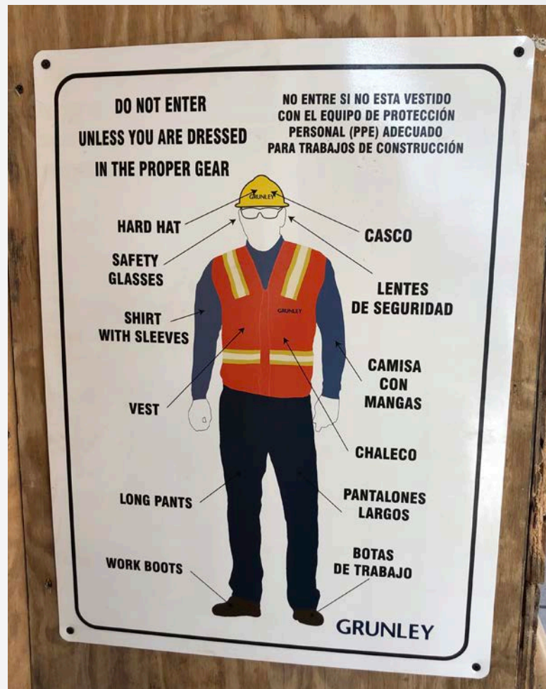
Plansjen viser påbudt verneutstyr på byggeplassen både på spansk og engelsk.
