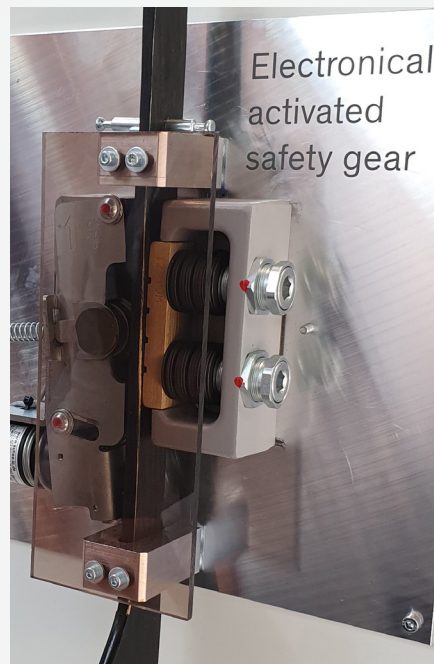
Elektrisk styrt fangapparat.
