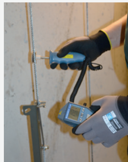
Her vises det hvordan man kan måle hastighetsbegrenserens utløserhastighet med ett tachometer.
