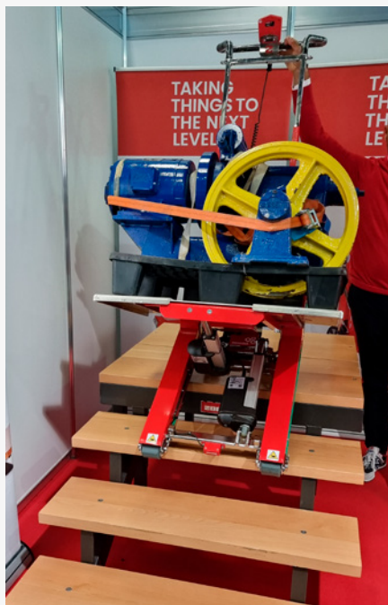
Trappemaskin for effektivt å kunne sjaue heismaskin opp trapper.
